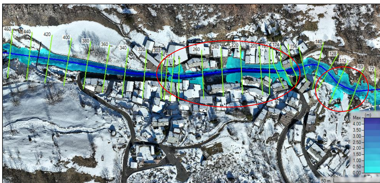
Figura 11 – Planimetria dei battenti idraulici massimi calcolati per la Q_{200} nelle condizioni dello stato di fatto.
