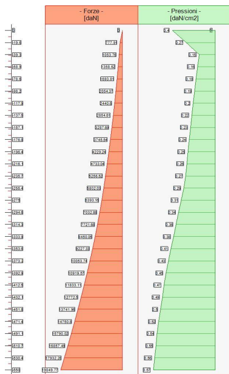
Forze (totali) e Pressioni lungo il fusto, per il Caso 2 ( GEO [ SLU_GEO ] - SLU A2+M2+R2 )
